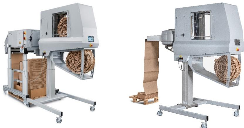
Le système PAPERplus® Coiler² traite les blocs de papier préformés par les machines PAPERplus® Classic, PAPERplus® Crossover ou PAPERplus® Track et les transforme en solides coils de rembourrage en papier. **Image : Storopack**
